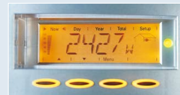
Das Fronius Personal Display zeigt die aktuellen Daten von bis zu 15 Wechselrichtern.
